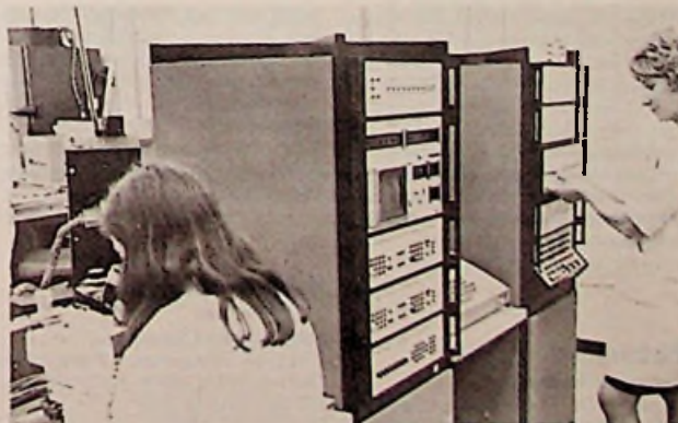
Computergestuurde, automatische testapparatuur. De circuits op elke wafer worden individueel getest.
